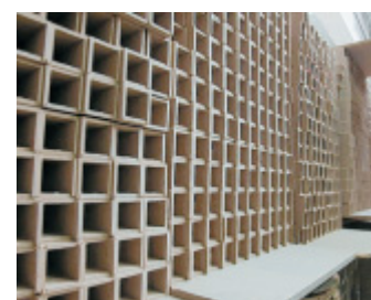
Tischbeine palettenweise: Von außen sehen sie massiv aus, innen sind sie hohl – eine Neuentwicklung der Firma MultiProfil.
